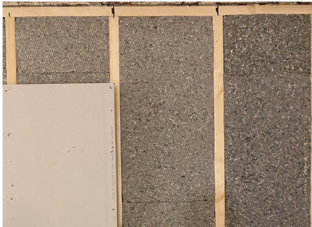
Figur B4.6: Uppbyggnad av vägg med trästomme och iCell, prov M4.
