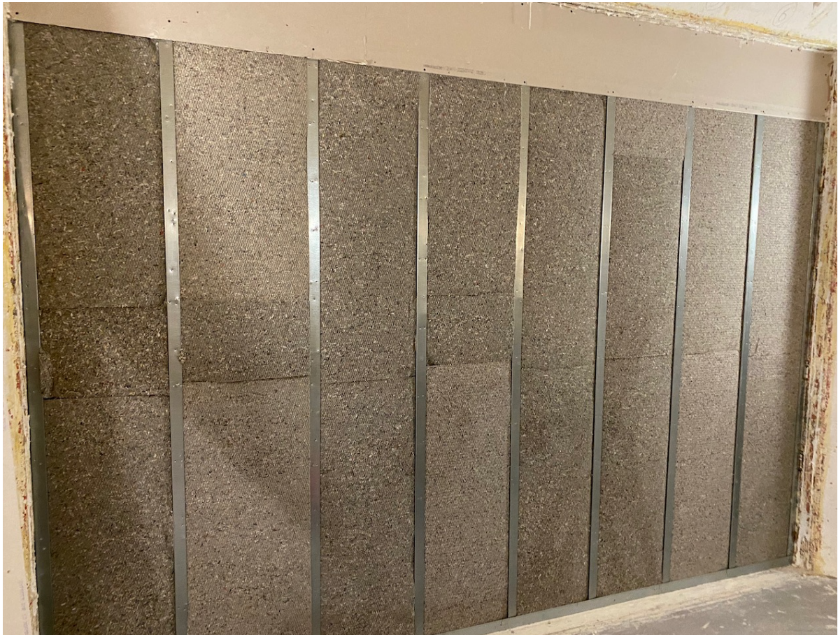
Figur B4.3: XR70-stomme med 70 mm iCell, för prov M2 och M3.
